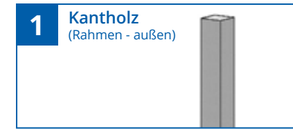
1 Kantholz (Rahmen - außen) Abmessung: 34 x 34 x 790 mm Anzahl: 4 Stück
